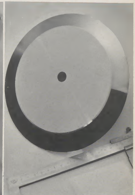
Große Wolfram-Telleranode für Röntgenröhren
