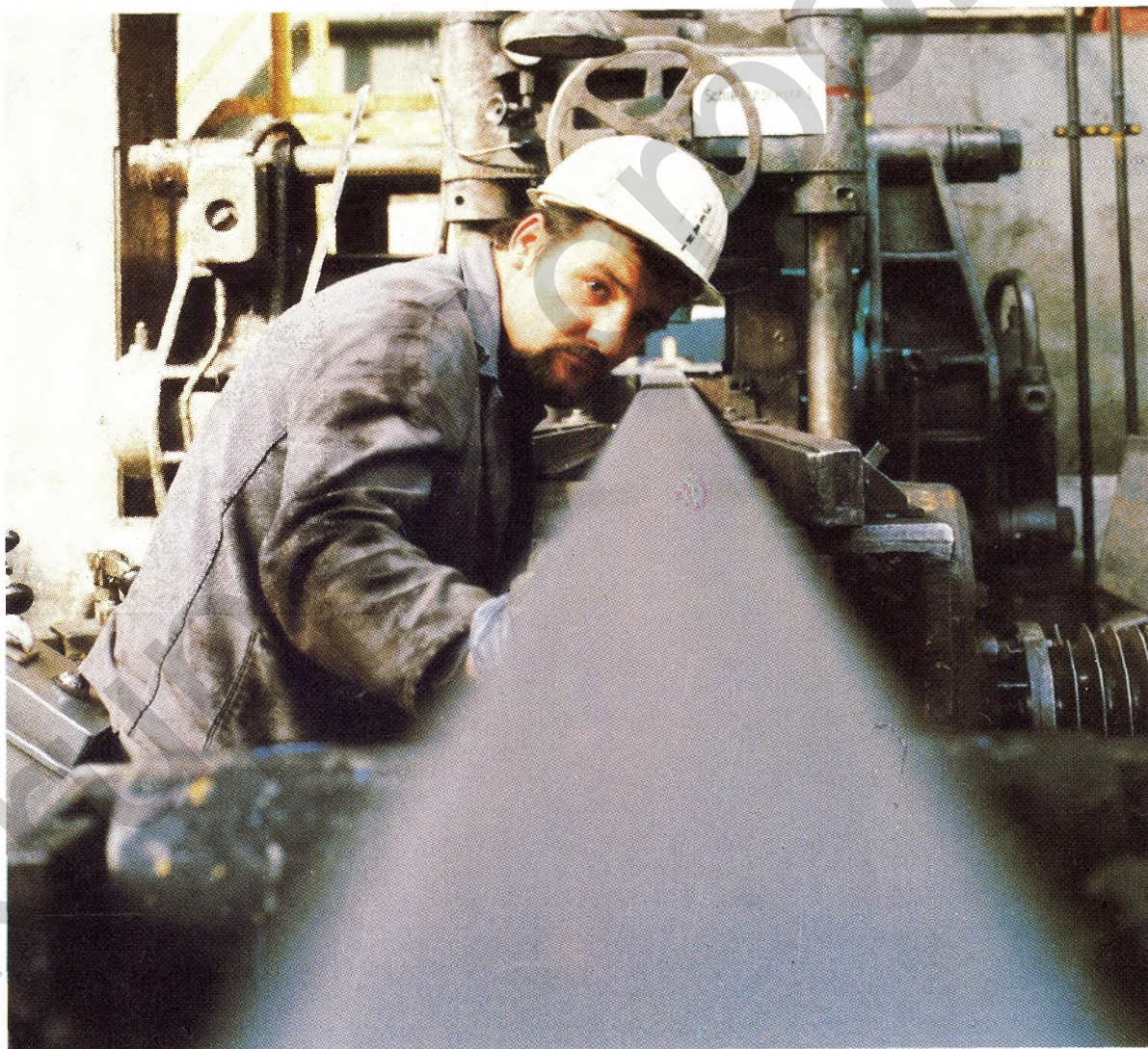
Ultraschallprüfung (Karl Heinz Reichelt, Vordergrund) im Durchfluß des Schienenmaterials hinter der Richtmaschine (Heinz Kaupel, Hintergrund) auf dem oberen Bild – und der Blick von Bernhard Schraren über das Schienenprofil an der Richtmaschine für die Schienenenden (unteres Bild) scheint zu sagen: „Die Richtung stimmt“.
