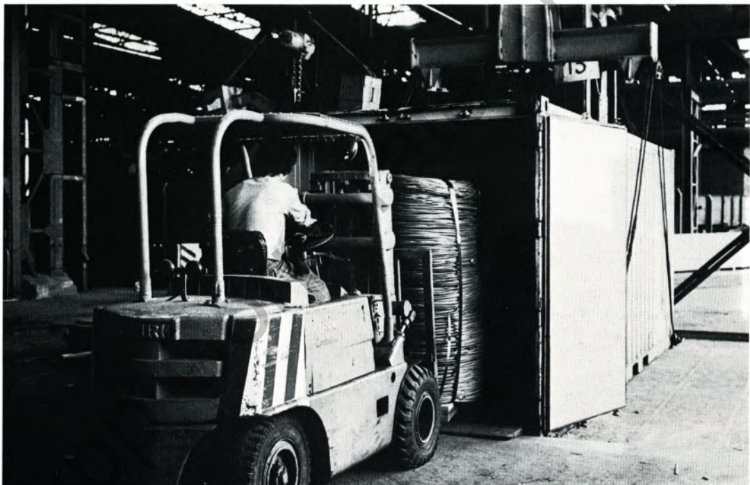
Schematische Darstellung LKW-Versand. Bild rechts: Mit der Verladezange wird ein Stahlcorddrahtbund auf eine Palette gesetzt. Bild darunter: Mit einem Hubstapler wird Stahlcorddraht in einen Container gefahren. Bild ganz unten: Der beladene Container wird mittels Krans auf einen LKW gesetzt.
