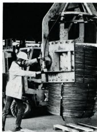
Schematische Darstellung LKW-Versand. Bild rechts: Mit der Verladezange wird ein Stahlcorddrahtbund auf eine Palette gesetzt. Bild darunter: Mit einem Hubstapler wird Stahlcorddraht in einen Container gefahren. Bild ganz unten: Der beladene Container wird mittels Krans auf einen LKW gesetzt.
