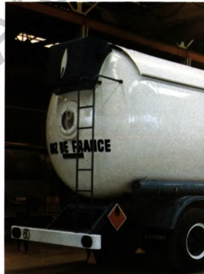
Druckbehälter zum Transport von Erde im TN-Preßwerk gepreßt.
