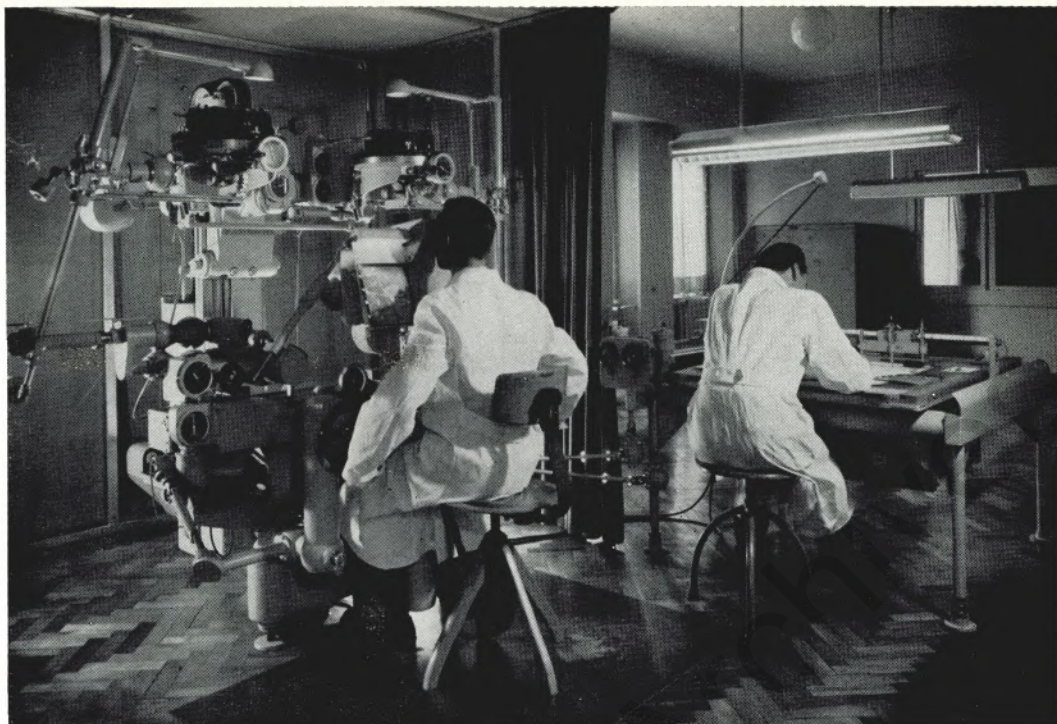
Blick in die Stereo-Meßabteilung bei der Auswertung von Luftbild-Aufnahmen. Links ein Zeiß-Stereoplanigraph mit einem Koordinaten-Druckwerk, ein Wunderwerk optischer Präzisionsarbeit. Der Auswerter folgt mit einer Meßmarke allen Linien des Luftbildes, zum Beispiel den Flußläufen, Wegen und Gebäudeliniien. Am Zeichentisch (rechts) entsteht dadurch automatisch eine photogrammetrische Kartierung, dessen Bleistiftlinien vom Zeichner (im Bilde) lediglich in Tusche ausgezogen werden. — UNTEN: In dieser Abteilung entstehen Bildpläne: Vorne links ein fast fertiger Plan, am Tisch rechts ein Zeichner bei Arbeiten an der entsprechenden photogrammetrischen Kartierung
