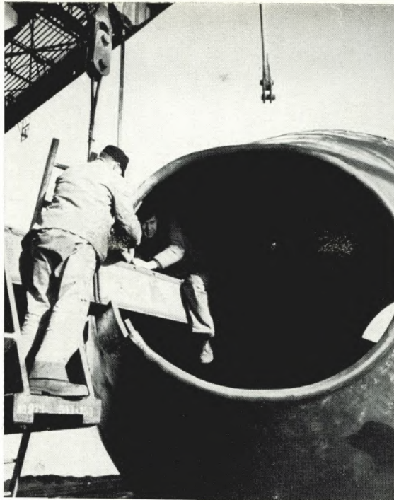
Mit Schrauben wird der Konverter am Fahrgestell befestigt. Das Kreuzstück (rechts hält ihn: vorne Obermeister Klein
