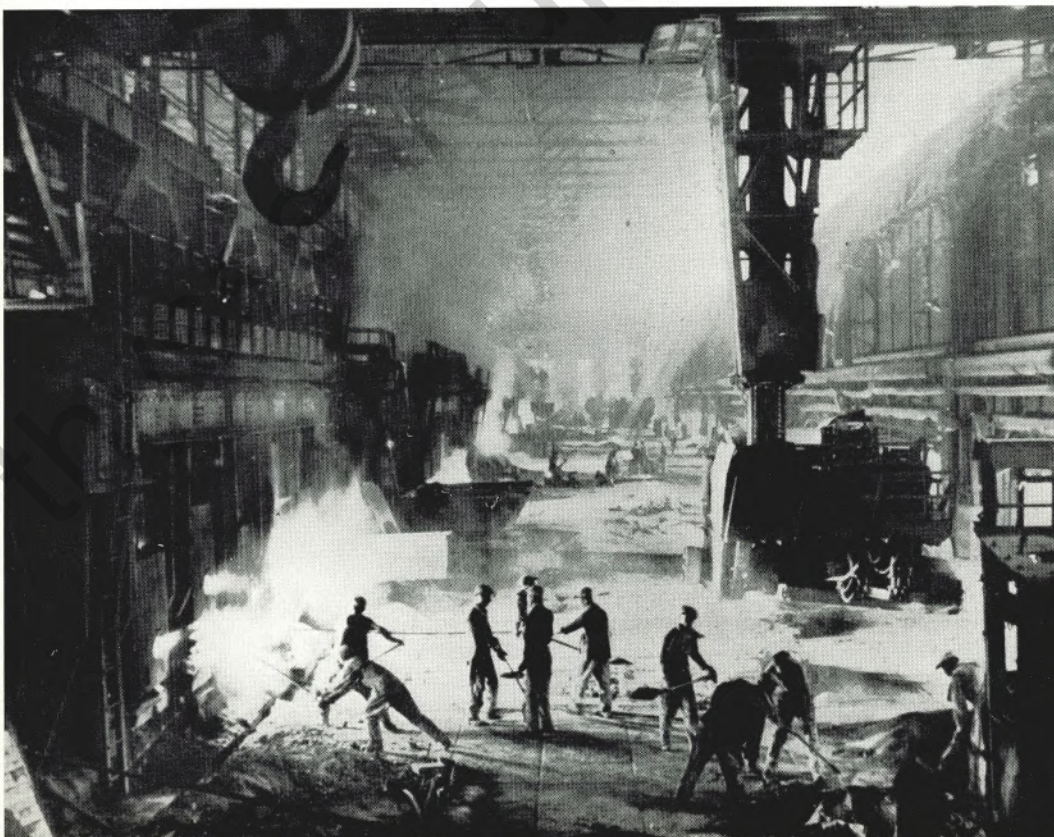
Dieses Bild zeigt die Ofenbühne eines modernen Siemens-Martin-Stahlwerkes im chinesischen Stahlzentrum Anshan in der Mandschurei. Im Vordergrund ein Chargierkran beim Beschießen eines Ofens
