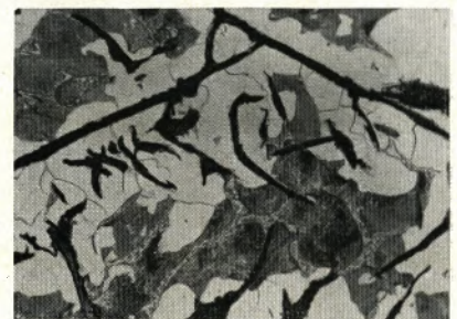
Mit Säure geätzte Schlitte, 100fach vergrößert. Oben Stahl und unten Roheisen
