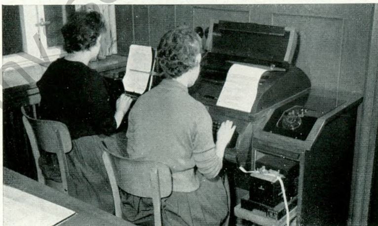
Bild 4 Blattfernschreiber mit Lochstreifenschreiber und Lochstreifensender
