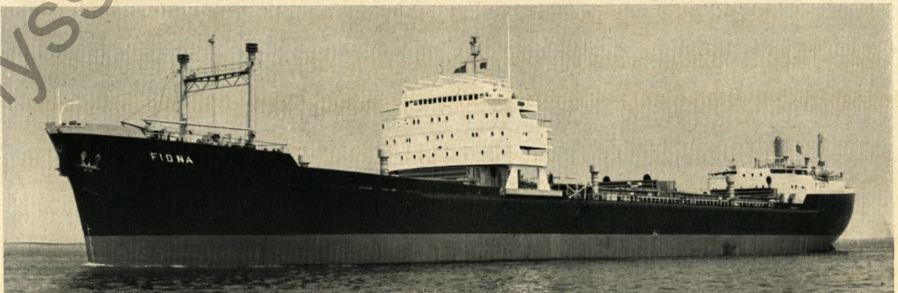
Der Massengutfrachter „Fiona“ auf hoher See. Das Schiff hat eine Ladefähigkeit von rund 27 000 t. Es wurde auf der Hamburger Werft
