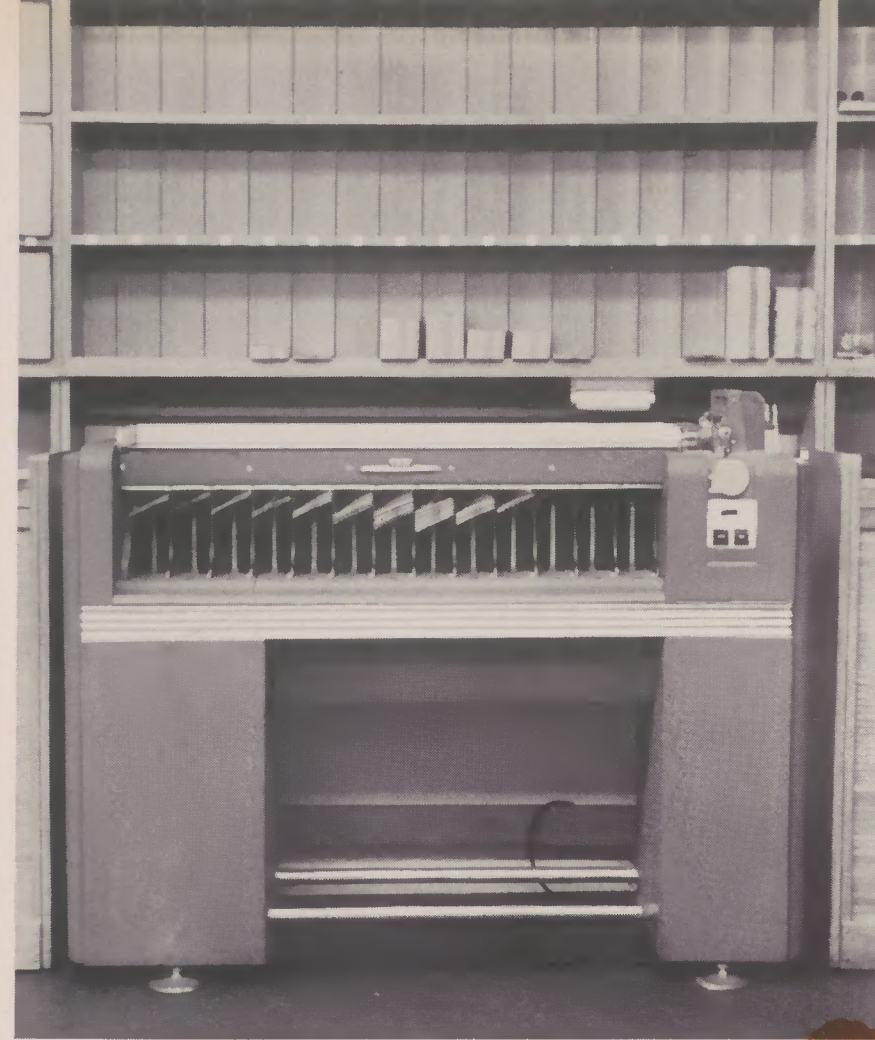
Diese Maschine dient zum Sortieren von Karten nach gewissen Merkmalen, um sie danach auswerten zu können.
