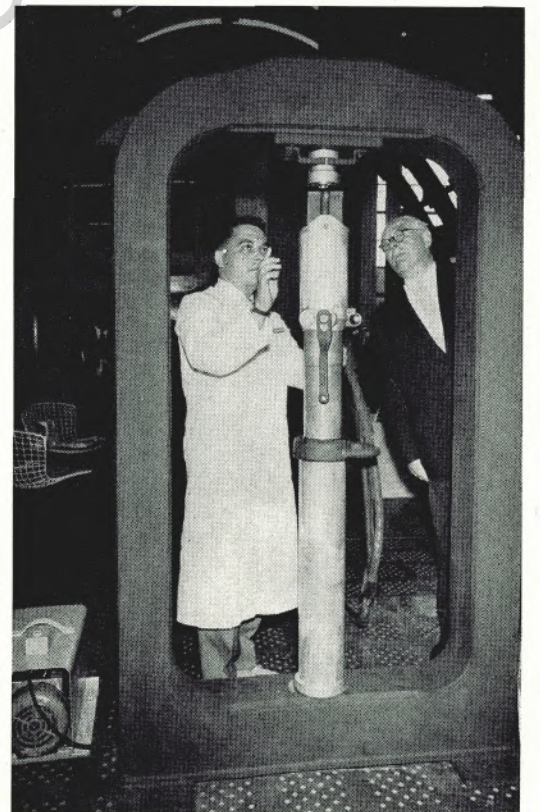
Ing. Kluge demonstriert dem Bürgermeister von Charleroi, Pinkers, die Arbeitsweise des hydraulischen Thyssen-Strebstempel N 60, System Noé
