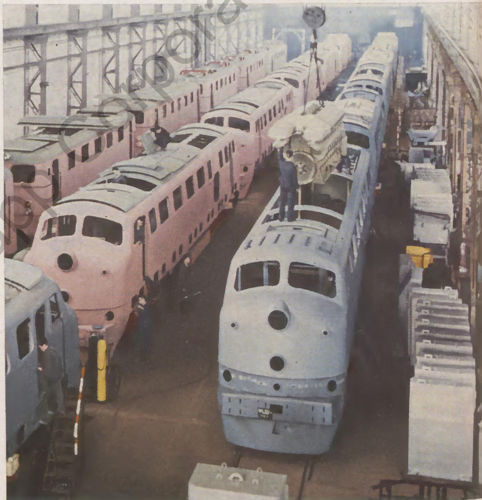
Blick in die Montagestraße der diesel-elektrischen Lokomotiven. — Bild oben: ein Ausschnitt aus unserer Lok-Produktion stellt sich vor der Lokmontage vor. Von links nach rechts: AA 16, DH 850, V 60, DH 700, DH 500, DH 240.
