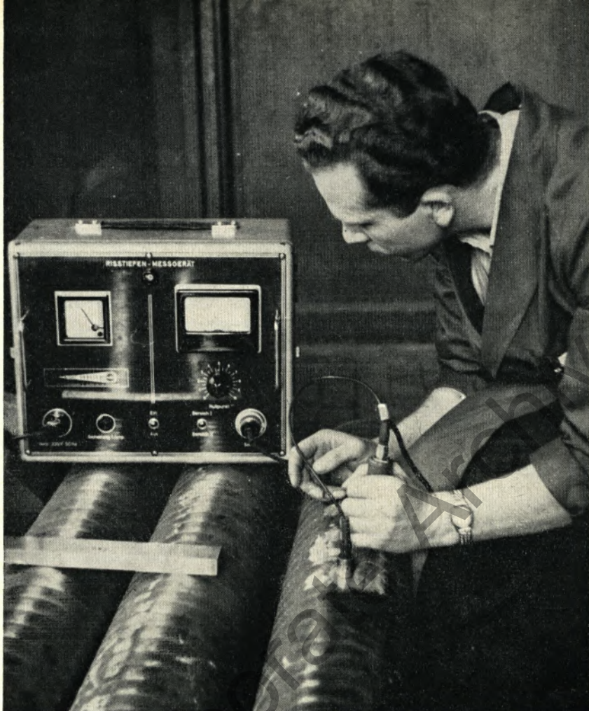
Eine Möglichkeit zur Ausmessung von Risttiefen bietet die elektrische Risttiefenmessung. Stoffprüfer Wönnmann bedient auf unserem Foto dieses Risttiefen-Meßgerät am Rundmaterial
