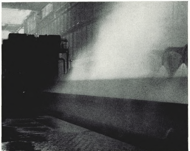
weniger eindrucksvoll ist der Wasser-Regen, der auf den Kühlrollgang hinter dem letzten Fertiggerüst der Warmbandstraße herunterprasselt und wie eine Fontäne zur Hallendecke aufsteigt, wenn er nicht von dem zum Haspel durchlaufenden, noch glühend-roten Band unterbrochen wird.
