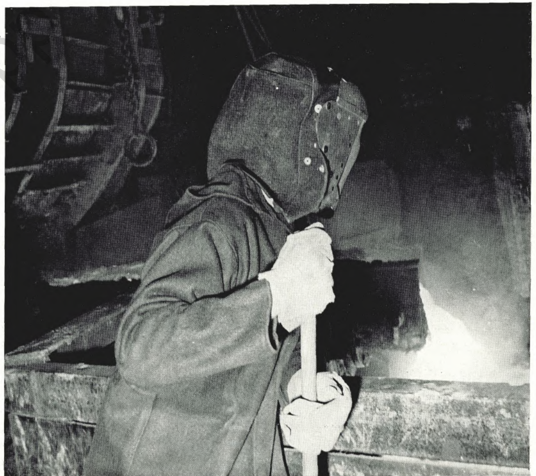
Abstich im SM-Stahlwerk der Armco Corp. in Middletown; Schmelzer Frank Neal bei der Arbeit
