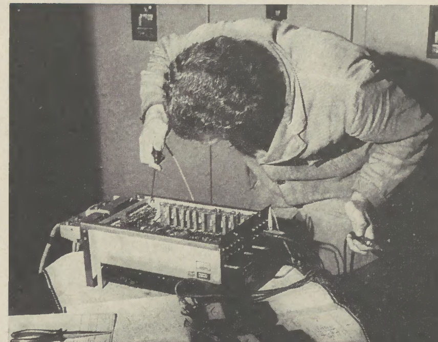
Einer unserer Fachleute, Elektro-Meister Thom, bei der Suche nach einem Fehler in der kontaktlosen Steuerung für die Stoßbank.
