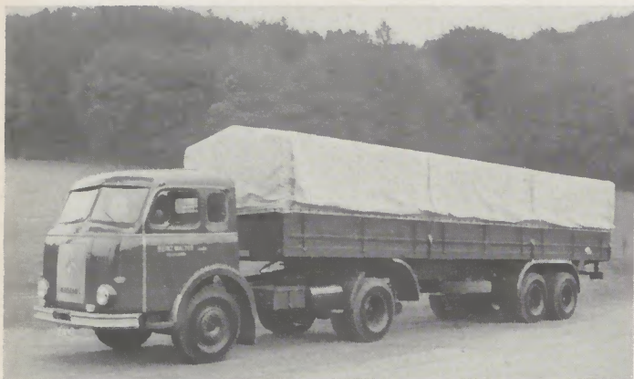
HS 145 TS mit Auflieger in Ferntransport-Ausführung
