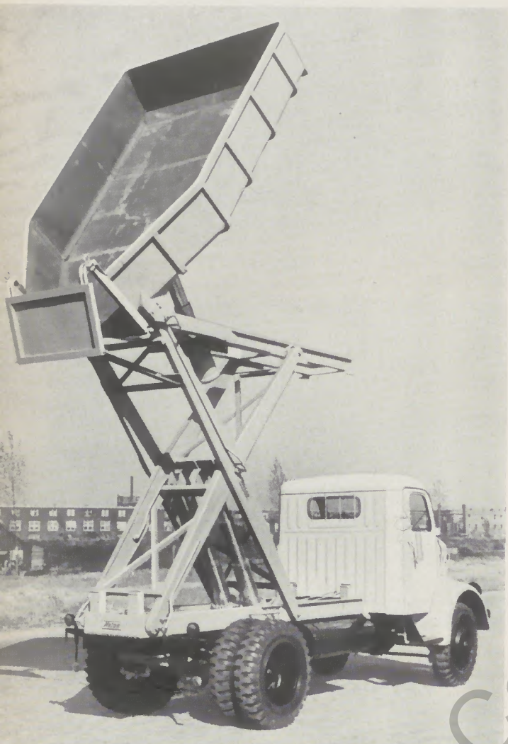
⑤ Der Hochkipper gestattet es, das Ladegut in höher als die Fahrbahn gelegene Behälter oder dergl. (Eisenbahnloren usw.) abzukippen. Trägerfahrzeug HS 100 AK.
