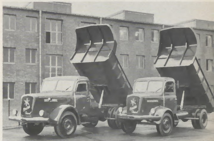
HS 100 K und HS 140 als Muldenkipper mit Stahldach als Fahrerhausschutz
