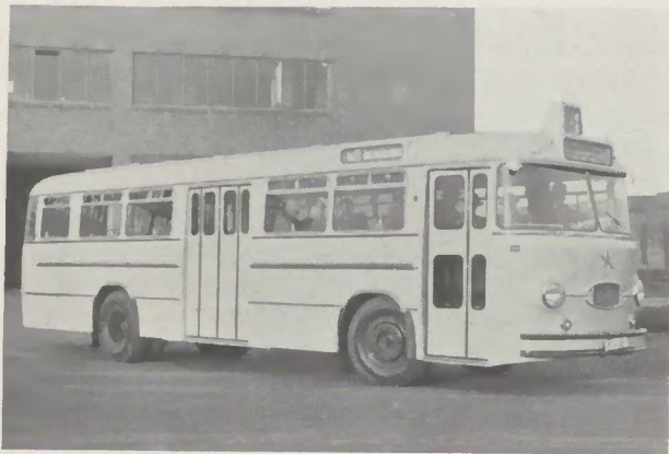
Auf Wunsch der Ustra - Hannover - wurde dieser Wagen, der seit über einem Jahr dort im Dienst stand, auf Luftfederung umgebaut, um einen Dauer-Versuch auch im betriebsmäßigen Einsatz durchführen zu können
