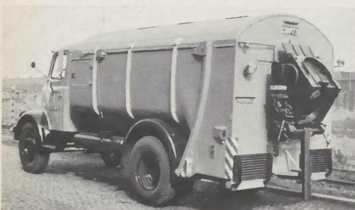
HS 100 Müllaufbau mit druckluftbetätigter Einschütt-Vorrichtung
