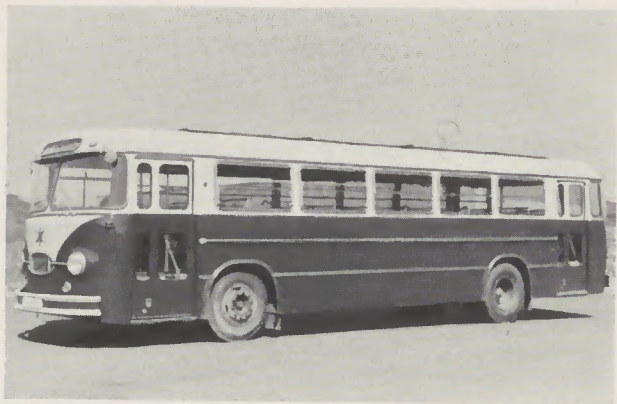
Rechtslenker für Einmannbedienung; Fahrgastfluß von vorn nach hinten. Der 11-m-Wagen läuft in Südafrika
