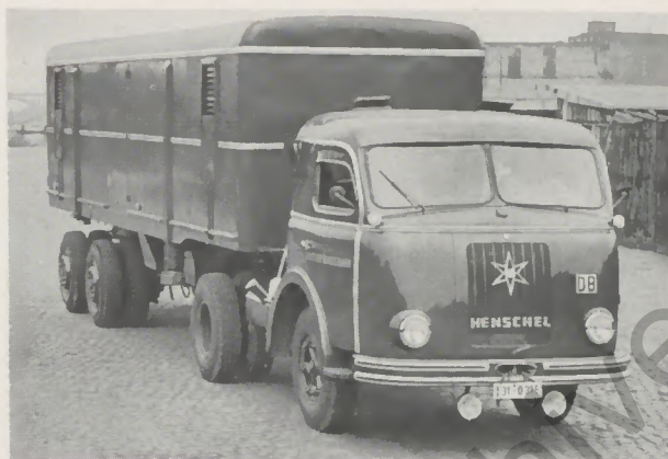
HS 145 TS mit Huckepack-Auflieger der Deutschen Bundesbahn
