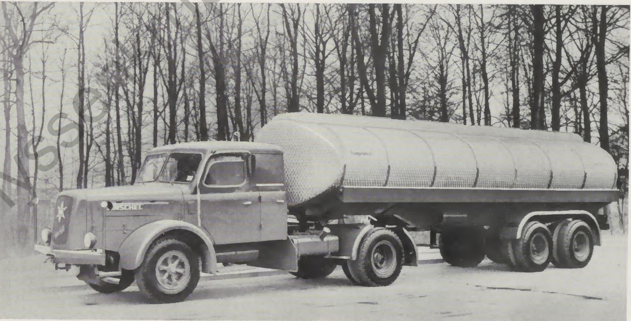
HS 140 S mit Tank-Auflieger für 31 000 kg Gesamt-Gewicht
