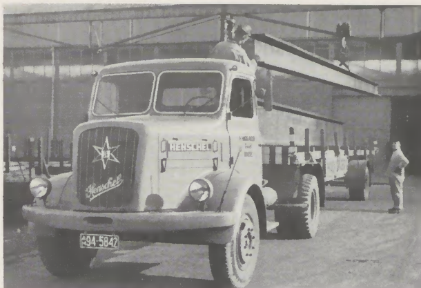
HS 120 S mit Auflieger für Langeisen-Transporte
