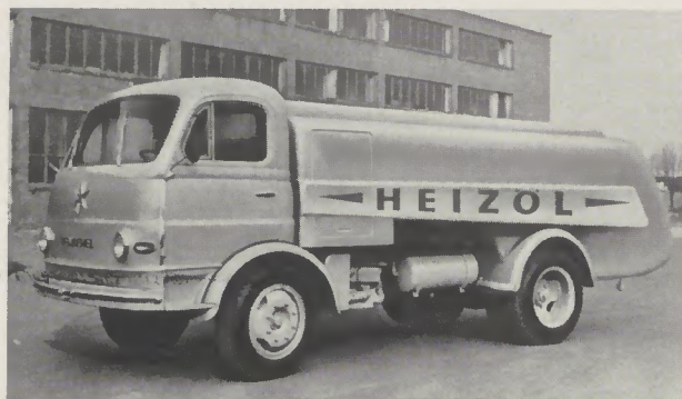
HS 90 mit 4400 l Heizöl-Tank
