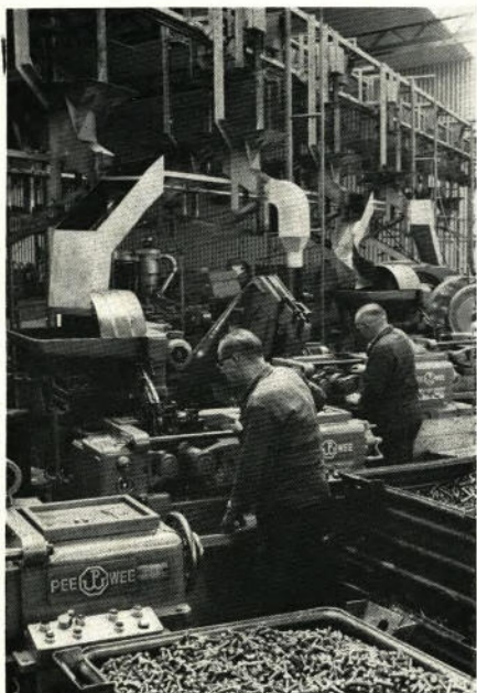
Titelseite: Ein Blick in die neue Werkhalle der Dörken AG, in der Schrauben, Muttern und Niete gefertigt werden. Unser Bild zeigt Automaten, die Gewinde auf Schrauben oder Bolzen „aufrollen“. Karl Behrens (links) und Otto Weyland richten die Maschinen ein und kontrollieren sie
