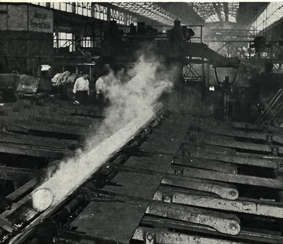
Ein Blick auf die Stopfenstraße 4 des Düsseldorfer Werkes Poensgen. — Rechtes Bild: Im Steuerstand der modernisierten Straße
