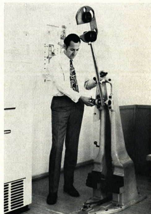
Bild links: Rolf Bongart und Egbert Schacht bei der Durchführung eines Zerreißversuches mit Feindehnungsmessung zum Bestimmen der 0,2-Grenze.
