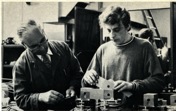
Einschachteln der Transformatorkerne für LSTK 132. Meister Wilhelm van Neer und Helmut Vaaßen.
