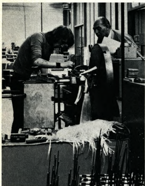
Fertigung von Transformatorwicklungen für Schweißgeräte. Von links: Klaus Hoff und Betriebsingenieur Max Thieme.
