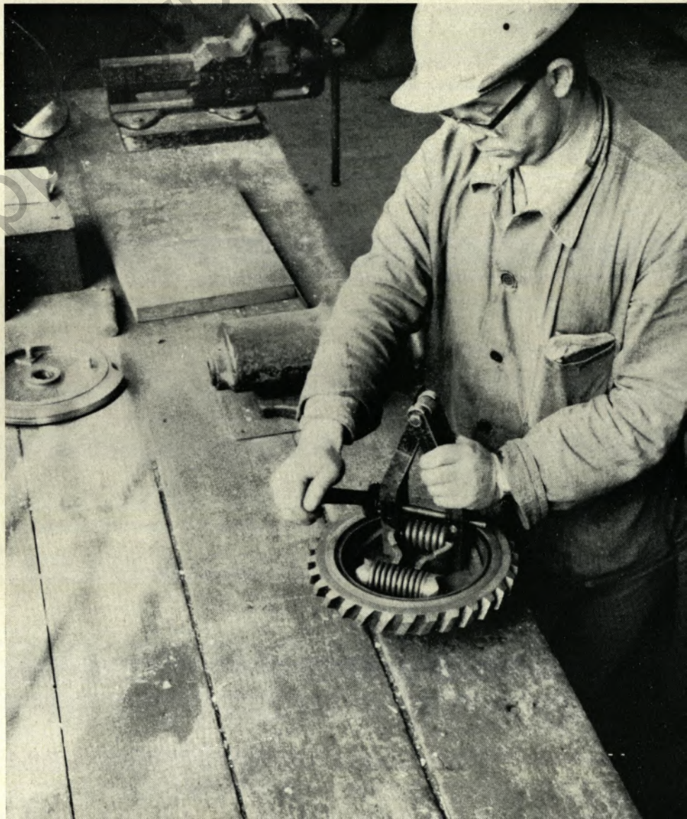
Verbesserte Montage mit der prämierten Spann- vorrichtung. Die Montage ist ohne Schraubstock und ohne den zweiten Mann möglich.
