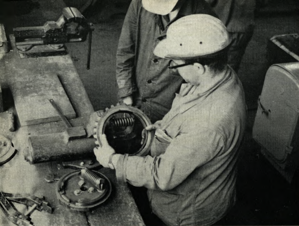
Montage der Kupplungsfeder in den Getriebelock des Weichenantriebes nach der alten Methode, wobei die Feder in einen Schraubstock gespannt und mit Hilfe eines zweiten Mannes eingesetzt werden mußte.
