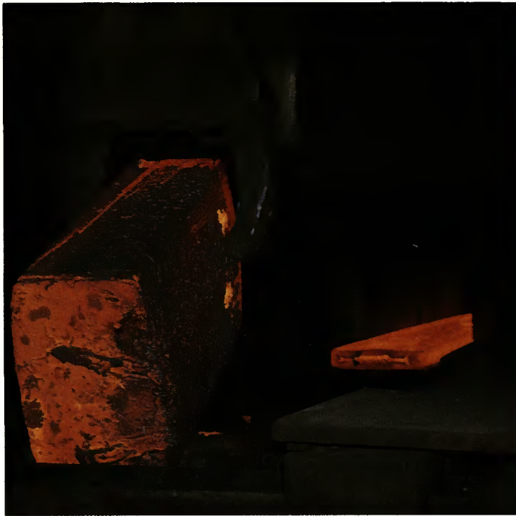
Eine aufgeheizte Rohbramme wird auf den Zufuhrrollgang zum Brammenwalzwerk abgelegt.
