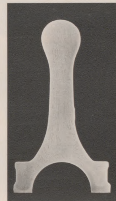
▲ Das Schlitfbild zeigt den für die Lebensdauer dieser Pkw-Pleuelstange notwendigen Faserverlauf
