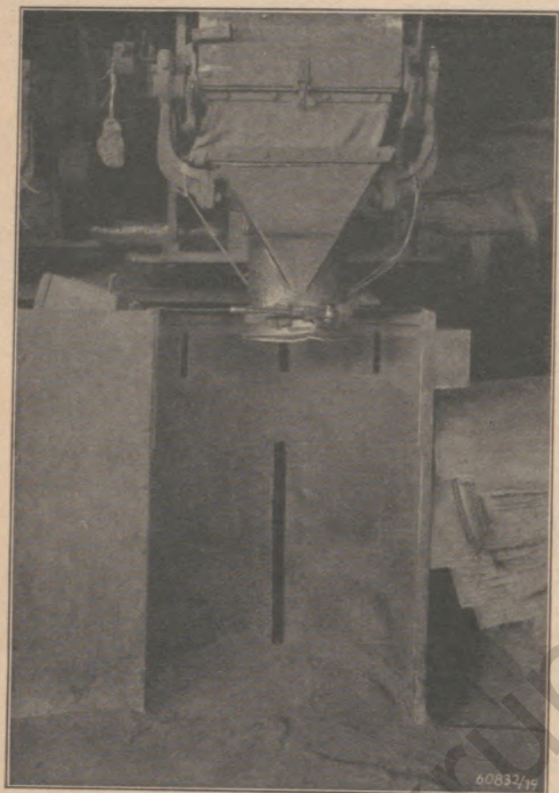
Bild 13: Starke Abjaugung des beim Abfüllen entstehenden Staubes durch angebrachte Schläge
