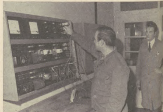
Bild 3: An diesem Lehrgerät nach dem Bauplattenprinzip können in kurzer Zeit Schaltfunktionen gesteckt werden.
