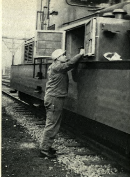
Kontrolle der Lok bei Schichtbeginn bzw. beim Restaurieren.
