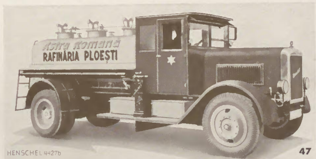
4500 Liter Inhalt - Fahrgestell 6CI mit 80 PS-Deutz-Diesel-Motor. Tank: Kofferform, 3 Abteile.
