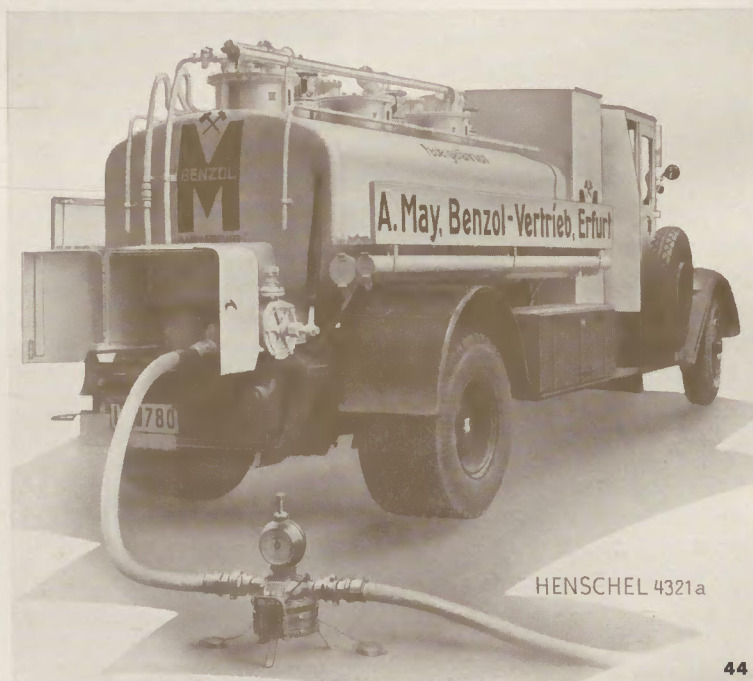
4700 Liter Inhalt — Fahrgestell 6C2 mit 85 PS-Motor. Tank: 3 Abteile mit transportablem Flüssigkeitsmesser, Kofferform.
