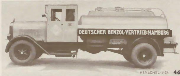
5000 Liter Inhalt - Fahrgestell 5CI mit 85 PS-Motor, Aluminiumtank, elliptische Form, 3 Abteile.
