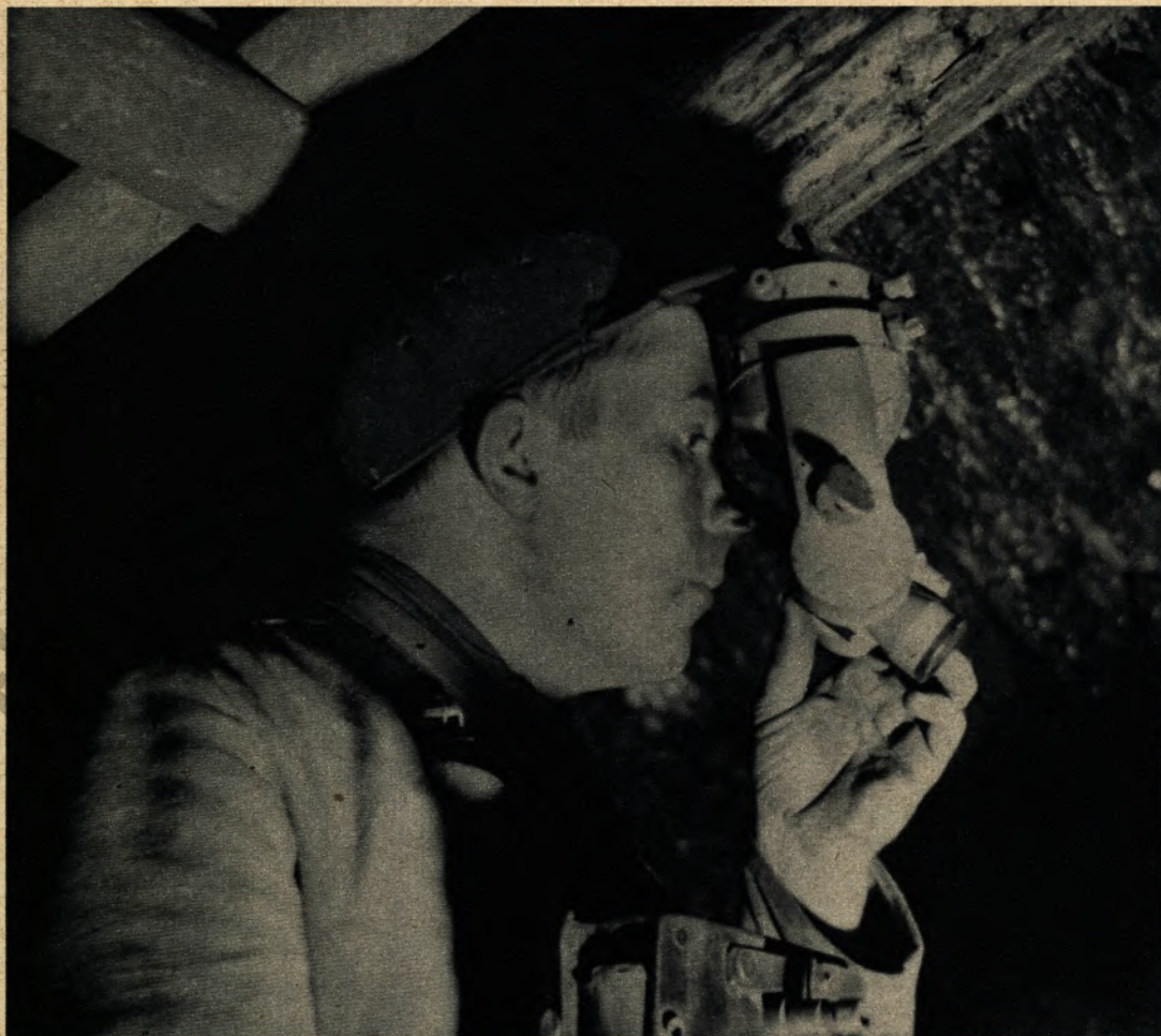
◀ Zu den Hauptaufgaben der Markscheider unter Tage gehört das Vermessen der Baue. Unser Bild zeigt Vermessungssteiger Günther Lente bei einer Messung am Hängetheodolit in der steilen Lagerung
