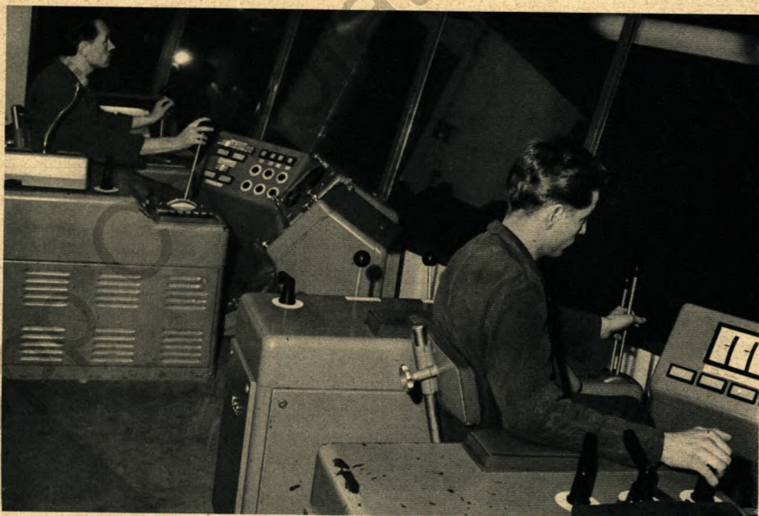
▲ Der 100-Tonnen-Stoßofen der Breitbandstraße wird mit Gichtgas von den Hochöfen geheizt. Rechts über dem Rollgang die Reglerbühne für den Ofen.
