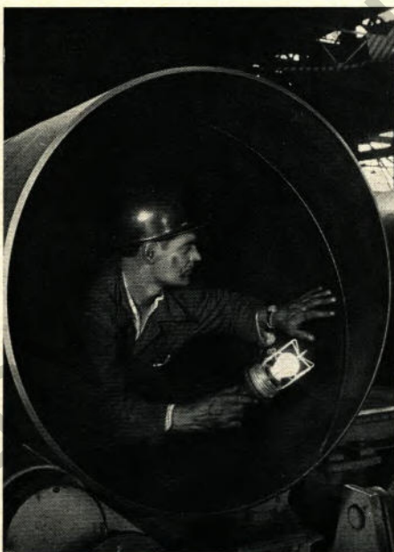
Rückseite: Nach dem Röntgen, bei dem die Schweißnaht unserer im Werk Dortmund-Barop gefertigten Spiralrohre durchleuchtet wird, überzeugt sich Herbert Jeschon von der Fehlerlosigkeit der inneren Rohroberfläche.
