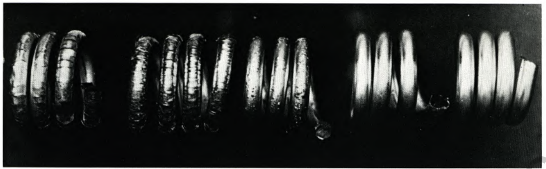
Haftung und Verformungsfähigkeit von Zinküberzügen auf Wickelproben.
