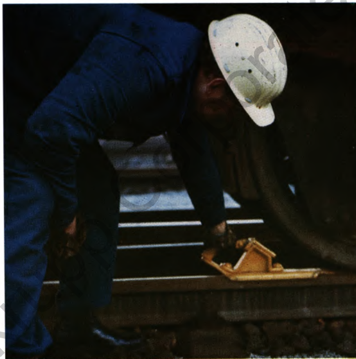
Ein abgestellter Waggon wird durch einen Hemmschuh gegen Entlaufen gesichert.
