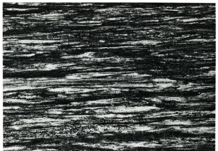
Bild oben: Patentierter Draht vier Millimeter. Bild unten: Patentierter Draht gezogen an 1,7 Millimeter.
