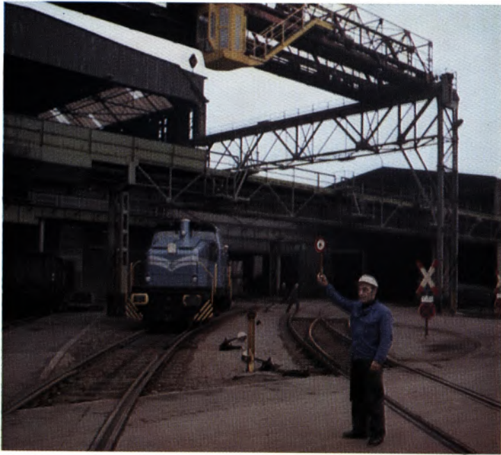
Bild links: Rangierer Heinz Lysiak sichert den Überweg zwischen Kantine und Schreinerei. Bild rechts: Bei einer geschobenen Fahrt muß der Fahrweg von der Spitze der Fahrinheit aus gesichert werden. Die Signale des an der Spitze auf dem Trittbrett stehenden Rangiermeisters werden von einem weiteren Rangierer an den Lokführer weitergegeben.
