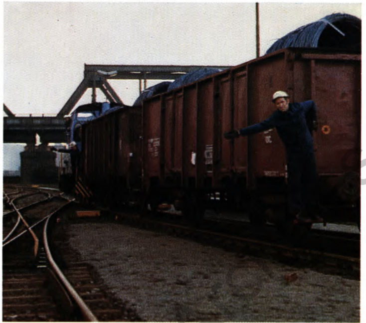
Bild links: Rangierer Heinz Lysiak sichert den Überweg zwischen Kantine und Schreinerei. Bild rechts: Bei einer geschobenen Fahrt muß der Fahrweg von der Spitze der Fahrinheit aus gesichert werden. Die Signale des an der Spitze auf dem Trittbrett stehenden Rangiermeisters werden von einem weiteren Rangierer an den Lokführer weitergegeben.
