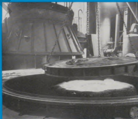
Eine Anlage zum Vakuum-Frischen von Edelstahl wird für den Betrieb vorbereitet. Dieses Verfahren wurde im Werk Witten entwickelt. Seite 12-13.
