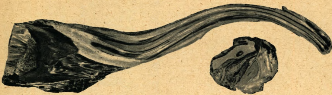
Gefüge eines römischen Brückennagels. Geätzter Längs- und Querschliff in natürlicher Größe
