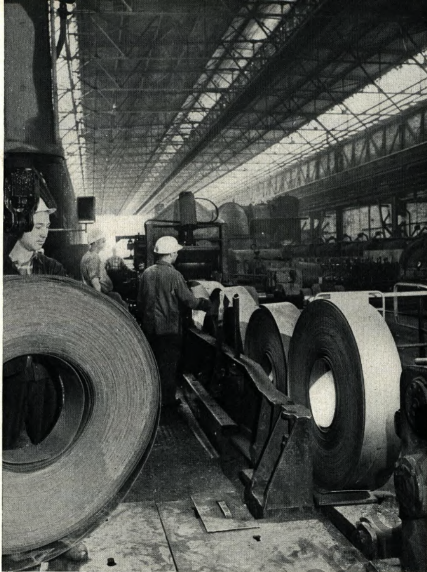
Vom Abrollkasten läuft das Band durch die Richtmaschine zur Endenschweißmaschine und wird zu einem kontinuierlichen Streifen aneinandergeschweißt. Von links H. Heidemeier und F. Knippel
