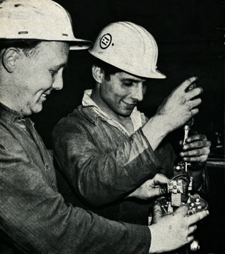
Gemeinsam mit Dieter Beigang arbeitet „Ali“ (rechts) an einer Magnetdruckluftsteuerung für die Umführungsplatten an der Walzenstraße 5
