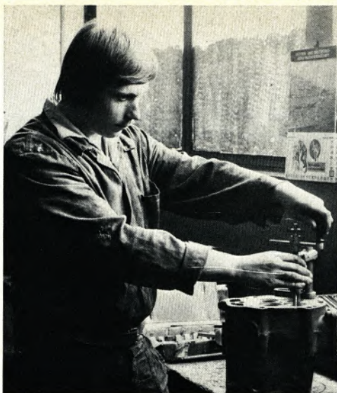
Kfz-Schlosser Helmut Hastermann beim Fräsen der Ventilsitze eines Zylinderkopfes.
