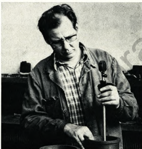
Bild oben: Motorenschlosser Hans Arnoldt mißt den Verschleiß an einer Zylinderlaufbuchse.
