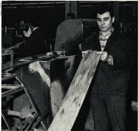
Eine neue Profilstraße wird mit dem Werkzeug 14/50 K eingefahren. Dieter Feiler (Entwicklungs-Abt.) prüft das Profil. Extruderführer Günter Becker steht bereit, um notwendige Korrekturen sofort durchzuführen. Auf dem rechten Bild stellt (im Hintergrund) Vorarbeiter Berthold Clausnitzer eine Fertigungsstraße ein. Vorn rechts prüft Mitarbeiter Ali Gögmen vor dem Bündeln der Stäbe die Schiebefunktion der Profile.
