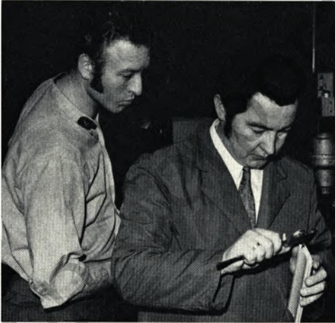
Eine neue Profilstraße wird mit dem Werkzeug 14/50 K eingefahren. Dieter Feiler (Entwicklungs-Abt.) prüft das Profil. Extruderführer Günter Becker steht bereit, um notwendige Korrekturen sofort durchzuführen. Auf dem rechten Bild stellt (im Hintergrund) Vorarbeiter Berthold Clausnitzer eine Fertigungsstraße ein. Vorn rechts prüft Mitarbeiter Ali Gögmen vor dem Bündeln der Stäbe die Schiebefunktion der Profile.
