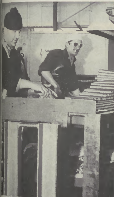
Zwei ausländische Rohrrevisoren beim visuellen und meßtechnischen Prüfen von Rohr-Fixlängen.
