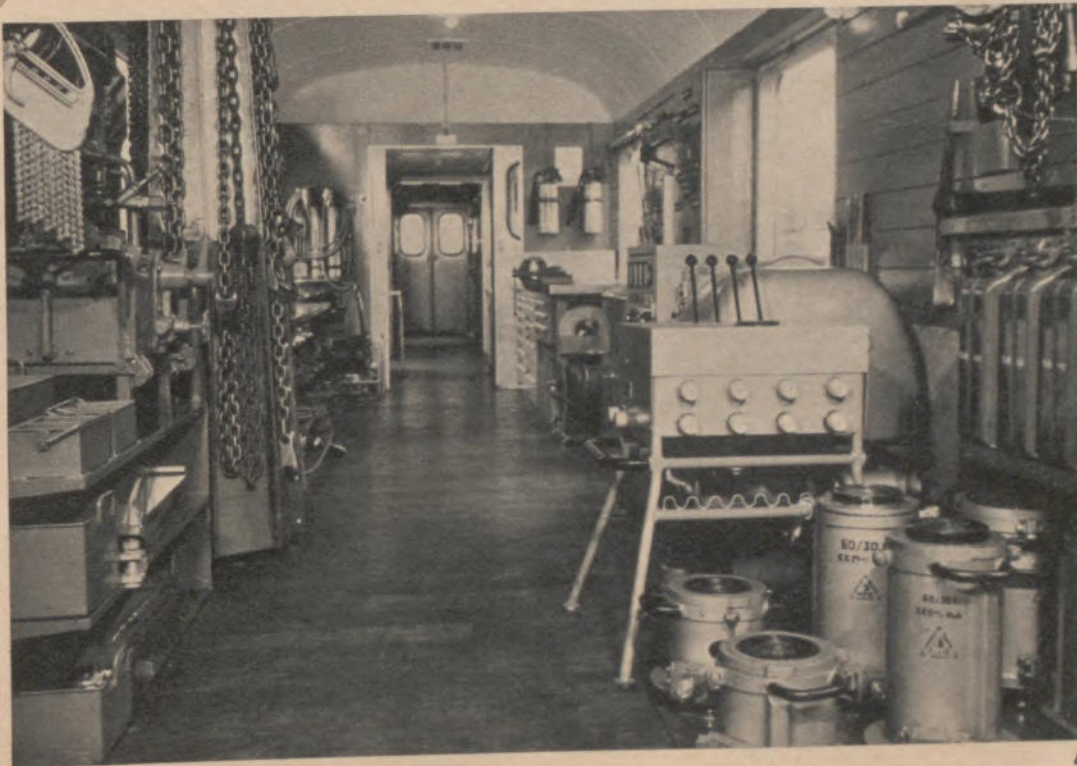
4 Das Hoesch-Aufgleisgerät gehört zu den wichtigsten Ausrüstungen eines Hilfszuges der Schweizer Bundesbahn. Beim Blick in das Wageninnere sieht man das Gerät rechts im Vordergrund
