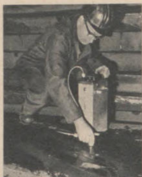
5 Im Warmbandwalzwerk der Westfalenhütte untersucht Joachim Bewermeier mit Ultraschall eine Vorbramme
