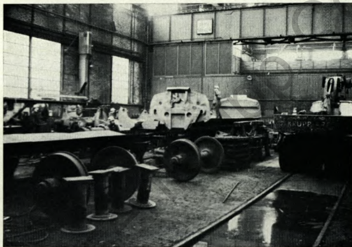
Reparatur von Hydraulik-Wagen (hier Zweiseiten-Kastenkippwagen) und Flurfördermitteln (hier Krupp-Mobilkran) noch in der Halle 2/3 (Lok-Reparatur).
