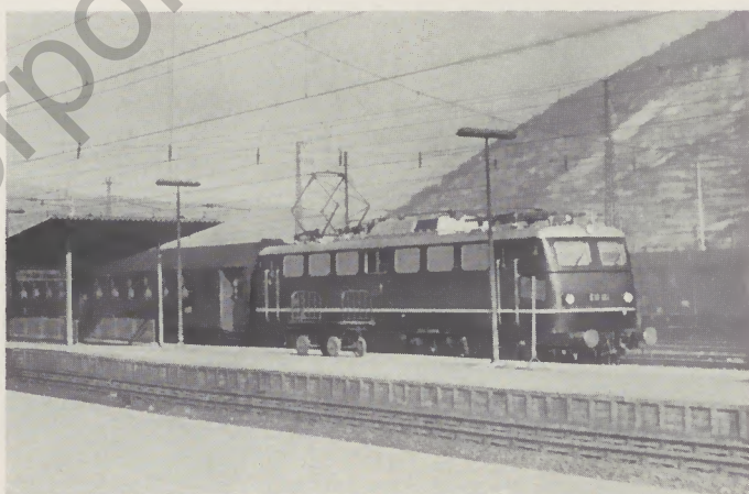
Abb. 1 Elektrische Bo'Bo'-Lokomotive Prototyp Baureihe E 10 der Deutschen Bundesbahn Gemeinschaftskonstruktion Henschel / Deutsche Bundesbahn 16 \frac{2}{3} Hz – 15 kV Dienstgewicht: 80 000 kp Stundenleistung: 4850 PS Höchstgeschwindigkeit: 130 km/h
