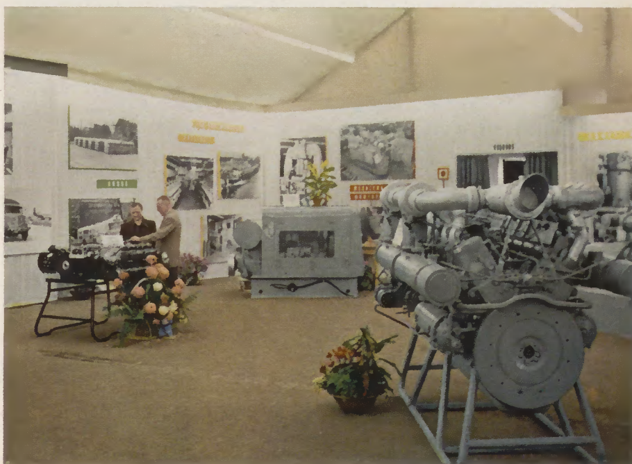
Rechts vorn ein 16-Zylinder-Schiffs-Dieselmotor in V-Anordnung. Links ein Unterflur-Dieselmotor (für Omnibusse).
