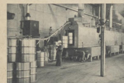
Die Faßproduktion der Blefa ist im Werk Attendorn zu Hause. Falzblätter werden an dieser halbautomatischen Anlage gefertigt. Die vorgebogenen Bleche (rechts) werden verschweißt – hier von Heinz Wojciechowski – und dann gebördelt (links), damit Boden und Deckel aufgesetzt werden können
