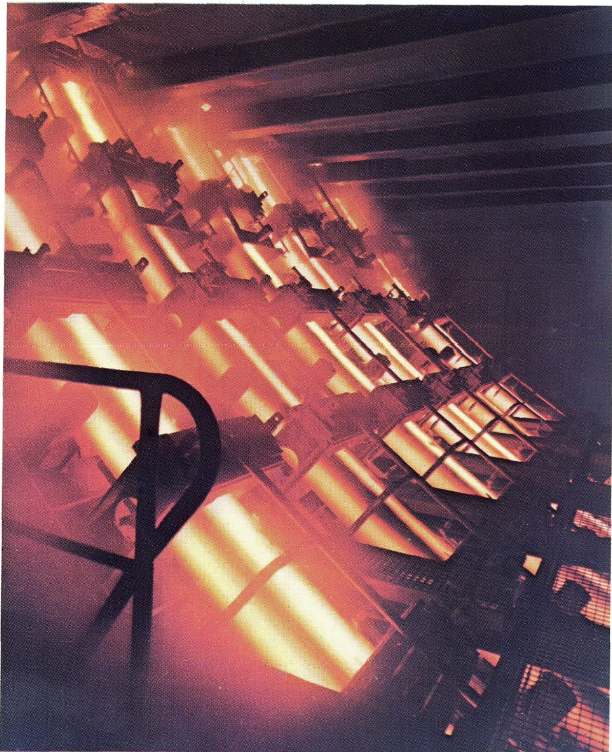
Deutlicher als Worte läßt dieses Bild erkennen, wie die sechs Stränge in einen Viertelkreis abgebogen werden.
