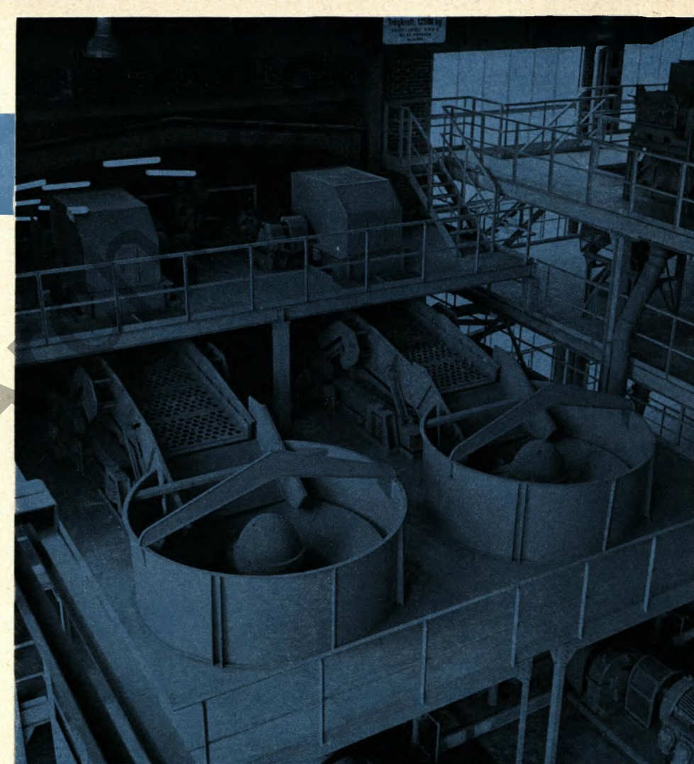
Unser Foto zeigt die Vorseibe und die Kegelbrecher der zweisträngigen Erzbrech- und Siebanlage im Nordhafen
