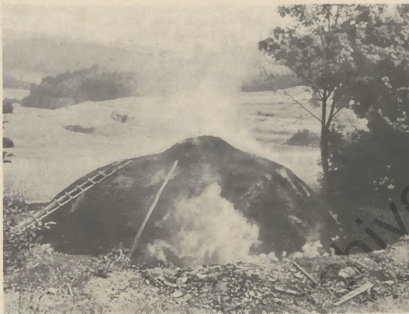
Der Meiler brennt je nach Trockenheit des Holzes etwa 10 bis 14 Tage. Der Ertrag ist ein Fünftel der Holzmenge.
