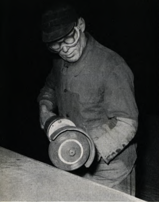
Dietrich Brillo beim Schleifen an einer Kesseltrommel
