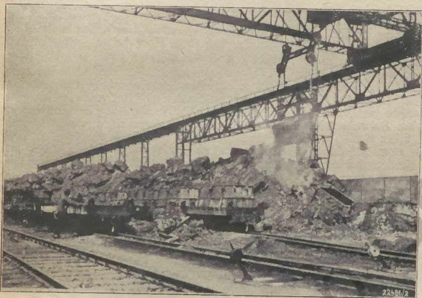
Die beim Erkalten zu Blöcken erstarrte Thomasschlade wird auf den Schlackenplatz gebracht
