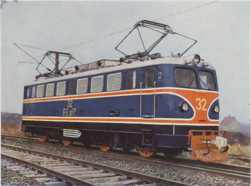
Abb. 3 Elektrische Bo'Bo' Lokomotive für die Portugiesische Staatsbahn, 50 Hz – 25 kV. Spurweite: . . . . . 1 665 mm Dienstgewicht: . . . . . 71 500 kg Stundenleistung: . . . . . 2 700 PS Höchstgeschwindigkeit: . . . . . 120 km/h
