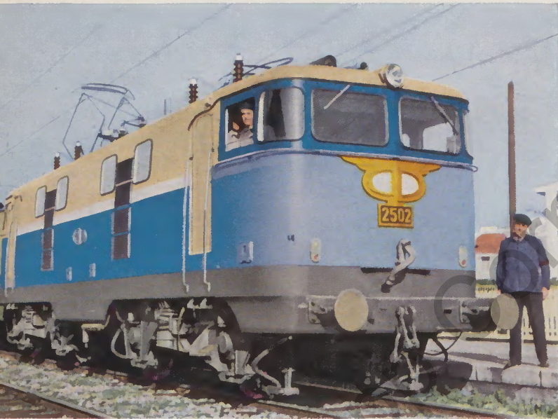
Abb. 3 Elektrische Bo'Bo' Lokomotive für die Portugiesische Staatsbahn, 50 Hz – 25 kV. Spurweite: . . . . . 1 665 mm Dienstgewicht: . . . . . 71 500 kg Stundenleistung: . . . . . 2 700 PS Höchstgeschwindigkeit: . . . . . 120 km/h
