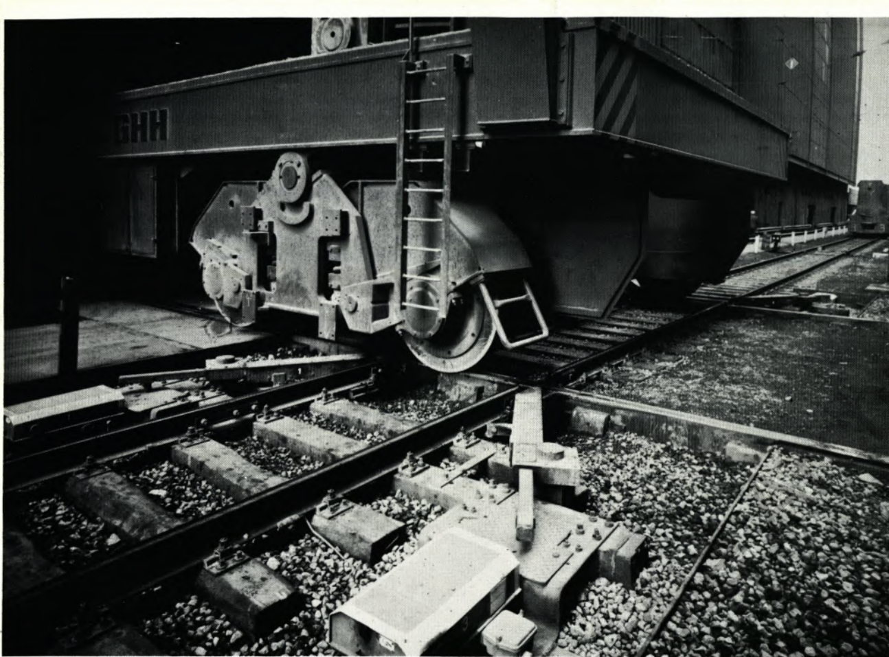
Der Stahl- übergabe- wagen beim Befahren der Kreuzung
