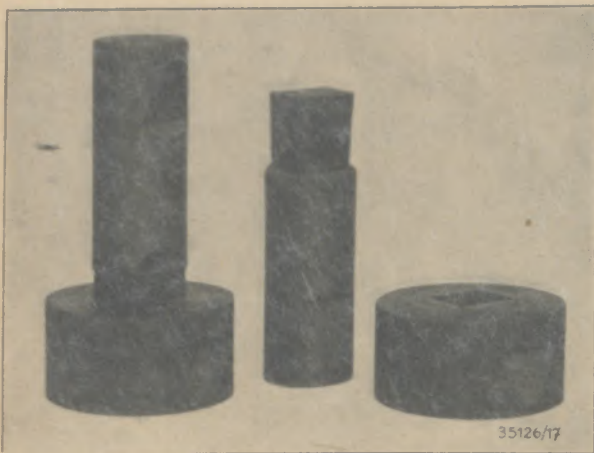
Bild 12: Facharbeit für Werkzeugschlosser: Stempel mit dazugehöriger Matrize, Ausführung
