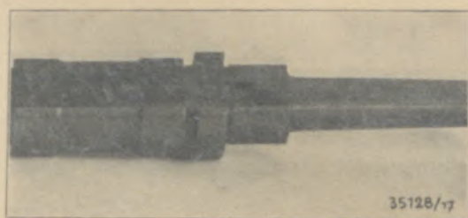
Bild 14: Facharbeit für Dreher: Aufspanndorn, Ausführung
