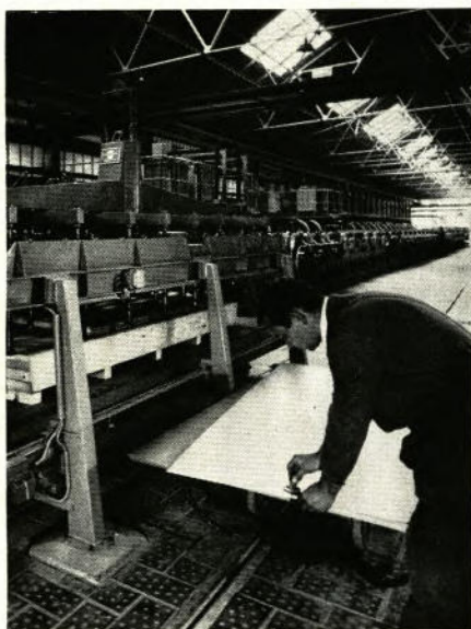
Titelseite: Auf dieser neuen Anlage im Werk Wuppertal der Trierer Walzwerk AG entsteht ZINCAL. Im Vordergrund die Entstapelvorrichtung, die die Bleche automatisch dem Behandlungsteil zuführt
