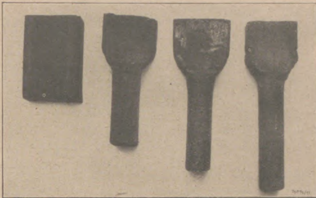
Abb. 1: Freiformschmiede Werdegang einer Ständerfußschraube
