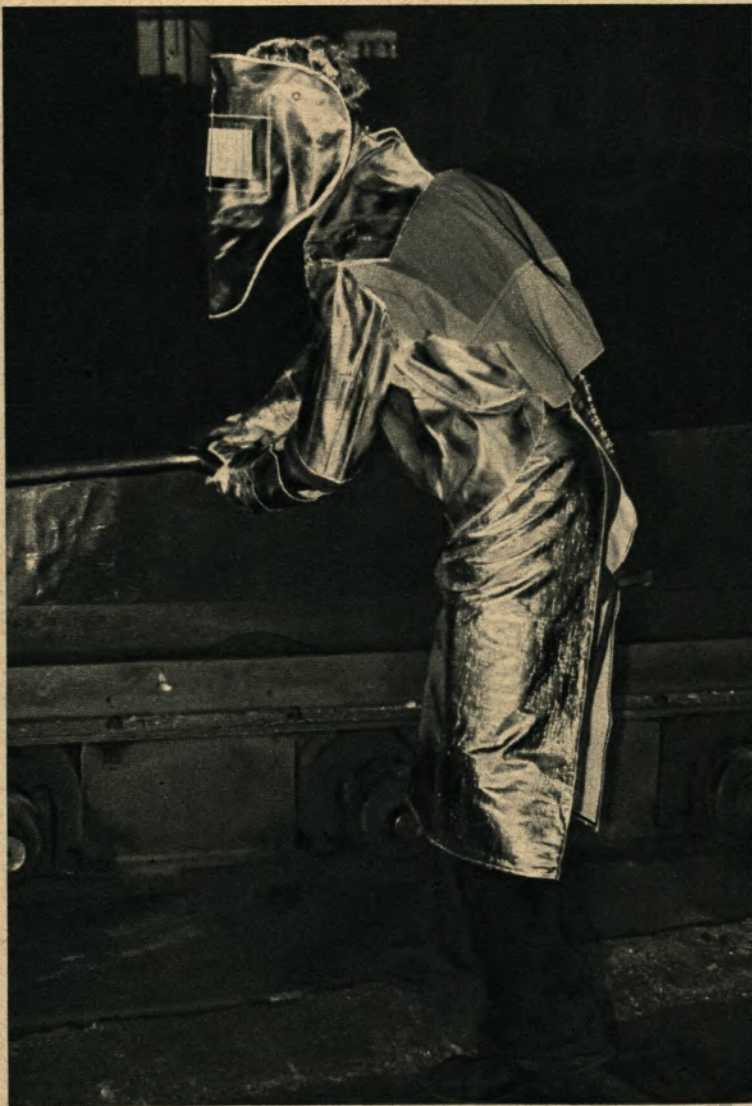
Mit Strahlungs- und Gesichtsschutz aus Aluminiumfolie an der Walzenstraße der Hohenlimburger Walzwerke AG.
