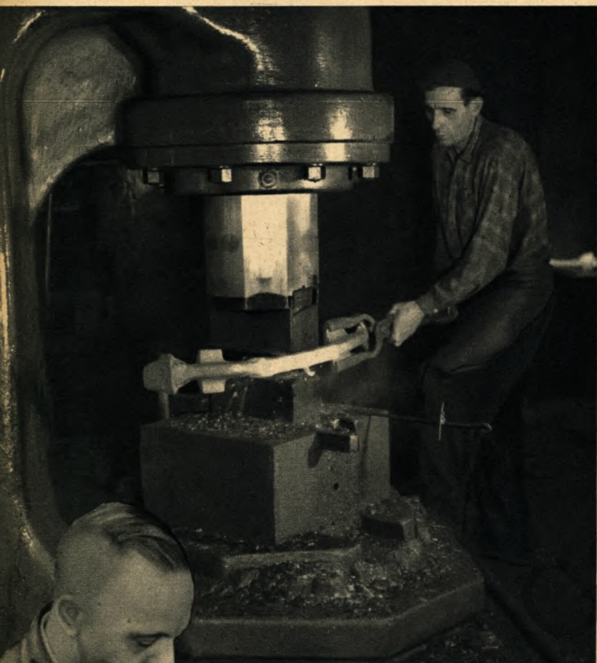
Fritz Blome schmiedet auf einem modernen Hammer bei der Schmiedag AG Fahrzeugachsen.
