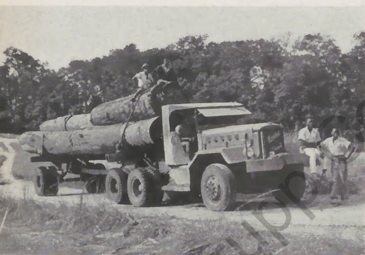
Holztransport in Belgisch-Kongo. Henschel Dieselmotor 513 DC (145 PS) eingebaut in einen Lastwagen vom Typ Diamond. Nutzlast 28 t
