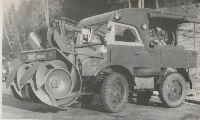
Unimog mit Schneefräse, angetrieben durch Henschel Dieselmotor Typ 512 DG
