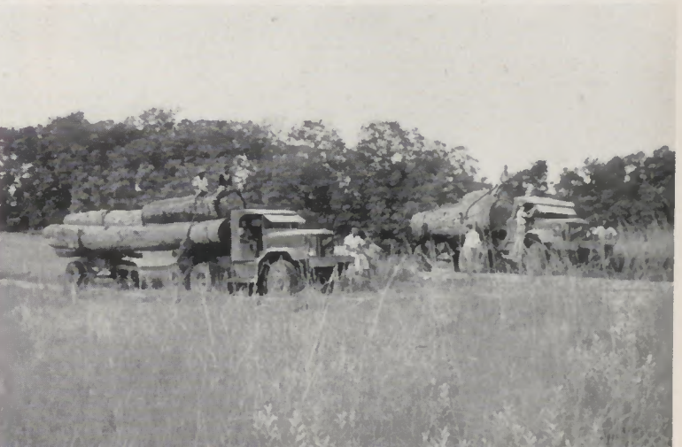
Holztransport der Firma Socoma aus dem Urwald nach Mayumba mit Diamond-Lkws mit Henschel Dieselmotoren 513 DC. Die Motoren haben bereits über 100 000 km in dieser Gegend gefahren. Die Wagen werden im Durchschnitt mit 25 t Holz beladen
