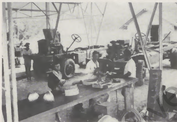
Werkstatt der Socoma in Louboma bei Mayumba, 600 km südlich vom Äquator. Hier werden Henschel-Motoren 513 DC serienmäßig in überholte Diamond-Fahrgestelle eingebaut
