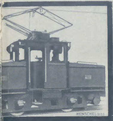
1929/30. Henschel-Bo-Elekt.-Lokomotive für Spei- und Oberleitungsbetrieb für Altos (Spanien). Meterspur.
