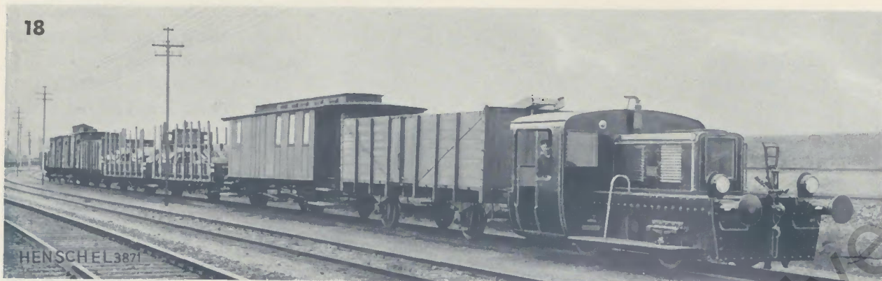
BENZIN-ELEKTRISCHE VERSCHIEBE-LOKOMOTIVE IM DIENST, ANHÄNGELAST 475 t IN DER EBENE
